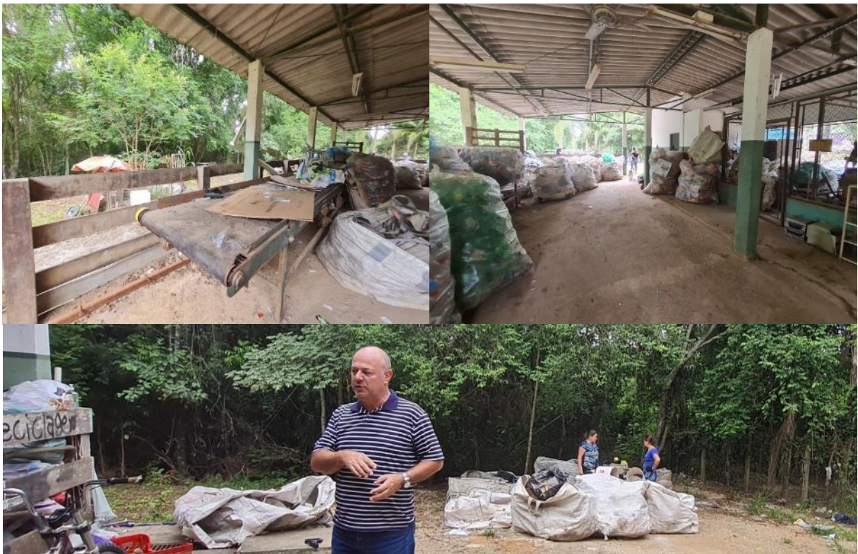
Figura 36: KATURETÊ – esteira quebrada (superior esquerda); armazenamento em bags/ sacos dos resíduos já triados em local coberto (superior direita); resíduos a serem triados à céu aberto (inferior)
